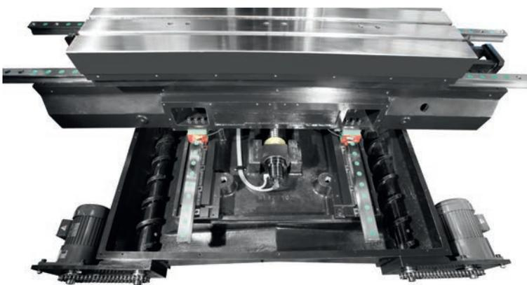
Zwei Schneckenspäneförderer in der Y-Achse (VF1100 & VF1300)
