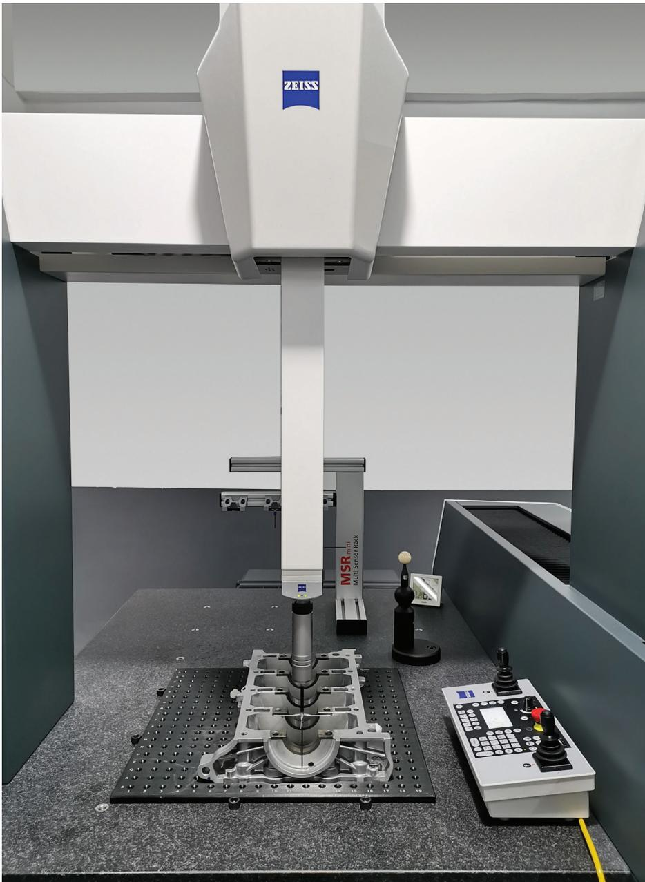
Werkstückvermessung durch CMM
